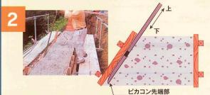
打設完了後、適当な時間経過後(参考15分~)再度ピカコンを 型枠表面に沿って、上下に動かしながら差し込み、底面に達した ら上下に動かしながらゆっくりと引き上げる。
