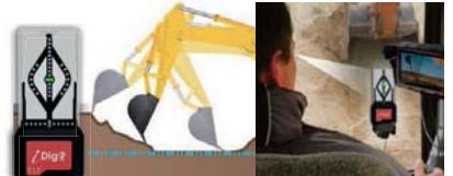
キャビン内でバケットの刃先位置を常時確認しながら、ブームオフセット時にも掘削作業ができ、掘削毎に標尺等を用いて掘削高を確認する作業が不要になります。
