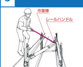
**4** 作業棒の先端のソケットをジャッキのスパナ口に差し込み、ラチェットレンチをセットし、仮締めする。
