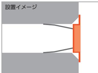
スリットがある水抜き穴に、足付のバネでしっかり固定できます。L型擁壁に最適です。
