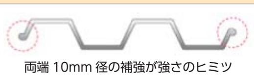
両端 10mm 径の補強が強さのヒミツ
