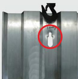
引抜作業での**破損**
