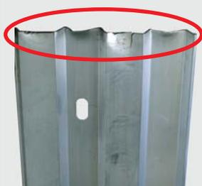
打込作業での**変形**
