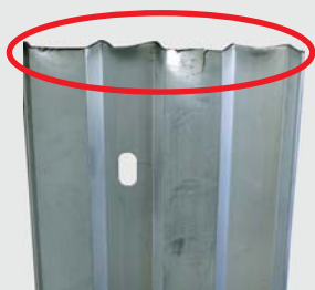
打込作業での 変形
