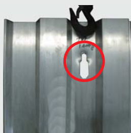
引抜作業での 破損
