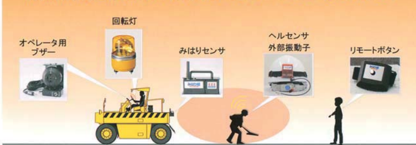
みはり組は重機後部に取り付ける発信部「みはりセンサー」と作業員のヘルメットに取り付ける受
